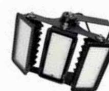
Керамические мощные светодиодные лампы в 5700 К (цветовая температура света), производя 135 Лм/Вт. Литой алюминиевый корпус с охлаждающими ребрами имеет порошковое покрытие. Прочное плоское стекло, которое надежно прикреплено со всех сторон, обеспечивая герметичность с классом защиты IP65. Кронштейны подвеса изготовлены из нержавеющей стали и обеспечивают надежное и проч-
